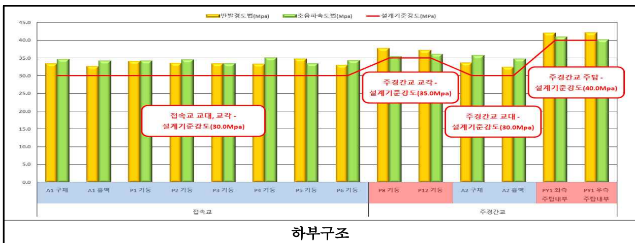
[그림 3.74] 하부구조 콘크리트 비파괴 강도 시험결과
