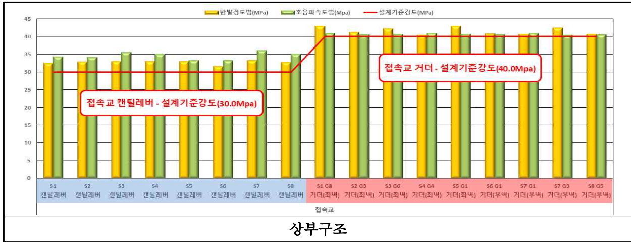
[그림 3.73] 상부구조 콘크리트 비파괴 강도 시험결과
