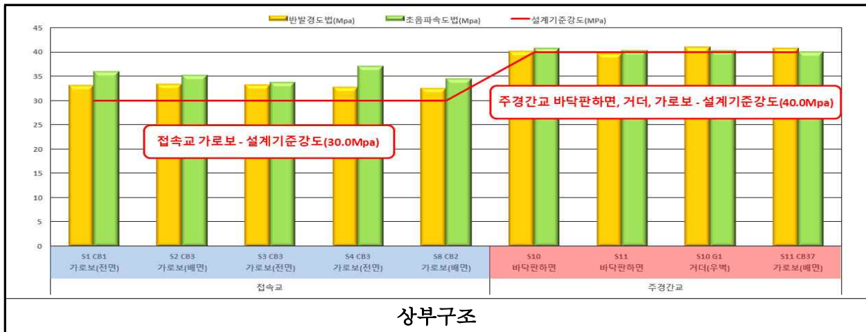
[그림 3.73] 상부구조 콘크리트 비파괴 강도 시험결과(계속)
